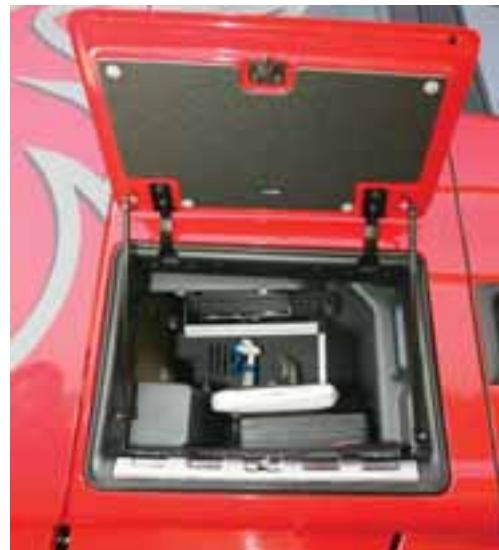
A külső tárolók mostantól felfelé nyíló fedéllel készülnek, megnövelt nyílásukon pedig az ásványvizes egységcsomagok is beférnek
